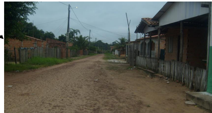
Figura 14 – Jardim Paraíso: rua sem drenagem, pavimentação e rede de esgoto (Foto: Flávia Cavalcante, 16/12/2010)
